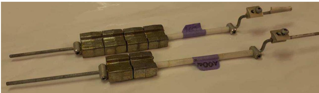
*Esempio di due ballasts per il Plus X: un 120gr e un 220gr. Grazie al sistema di fissaggio, è molto facile regolare la posizione del ballast per ottenere il giusto CG.*
